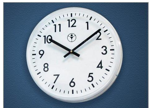
**СВ.ОМС.30Б.ДС24.П.АЦ** Часы стрелочные вторичные односторонние с монтажом на стену, диаметр корпуса 30 см, цвет корпуса белый, управляются секундными импульсами чередующейся полярности с амплитудой 24В, стрелки прямые, разметка циферблата арабскими цифрами.
